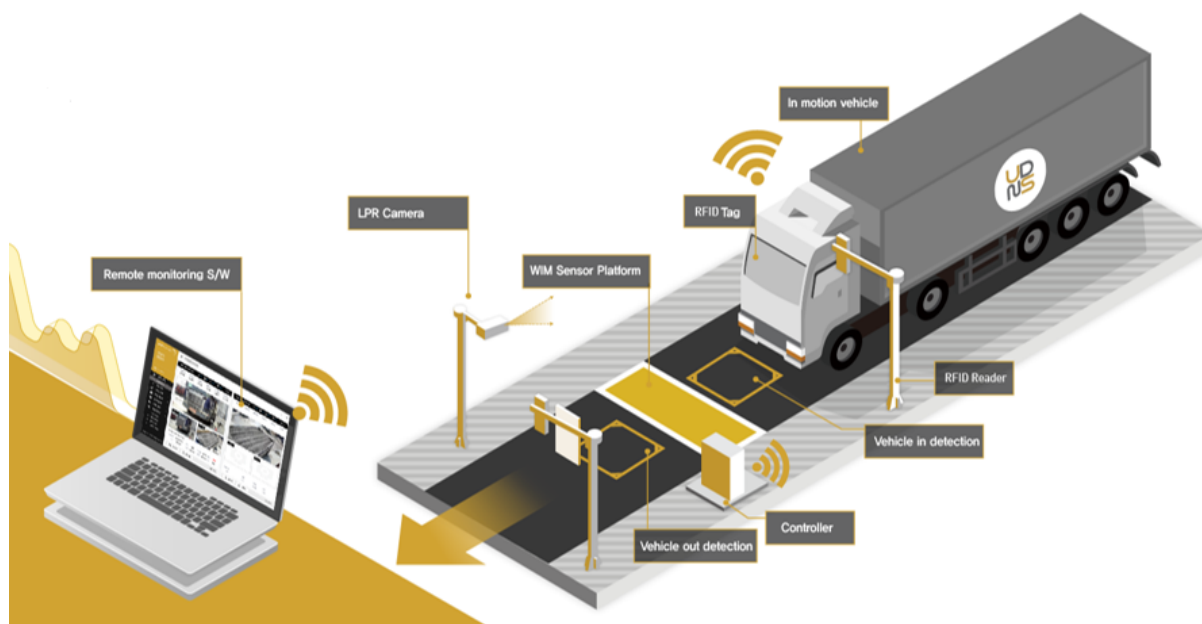
Figura 43 – Exemplu de Sistem de cântărire în mișcare a greutăților pe osie în cazul transporturilor grele
